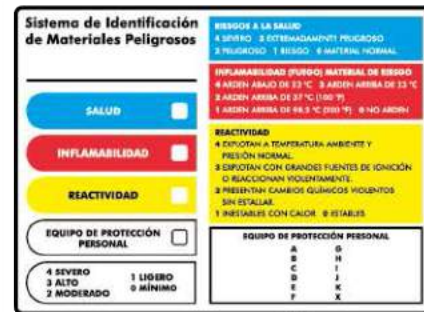
Diseño 1108 Sistema de Identificación de Material Peligroso
